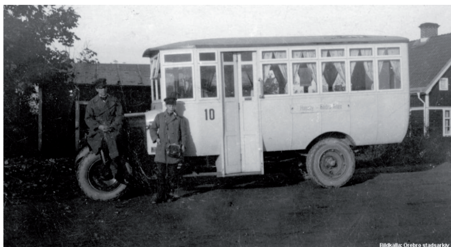
Buss nr 10, en Stewart 1924, registreringsnummer T760, motoreffekt 43 hkr, med plats för 23 passagerare. Trafikerade sträckan Hagaby – Södra Allén på 1920-talet.
